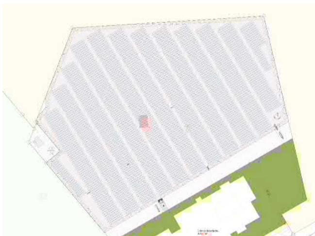
Abb. 10: Vorgesehene Modulbelegung der Fläche
